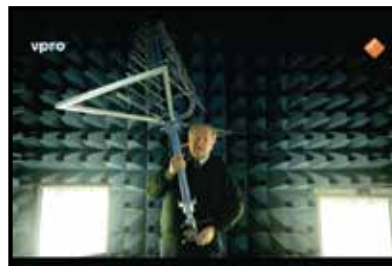
Directeur van Holland Shielding, Jan van Tienhoven met een antenne in een echovrije meetruimte waar de straling of gevoeligheid van apparaten wordt gemeten. Still uit Offline als luxe , 2016, VPRO Tegenlicht , regie: Bregtje van der Haak.
