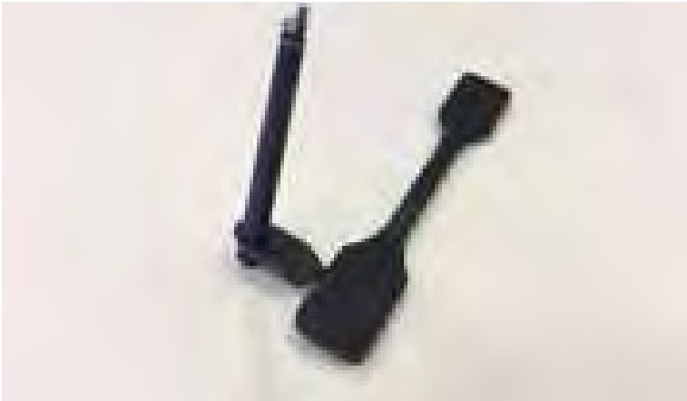
Afbeelding 2.8 Spuitgegoten proefstaafje van PLA/denim.
