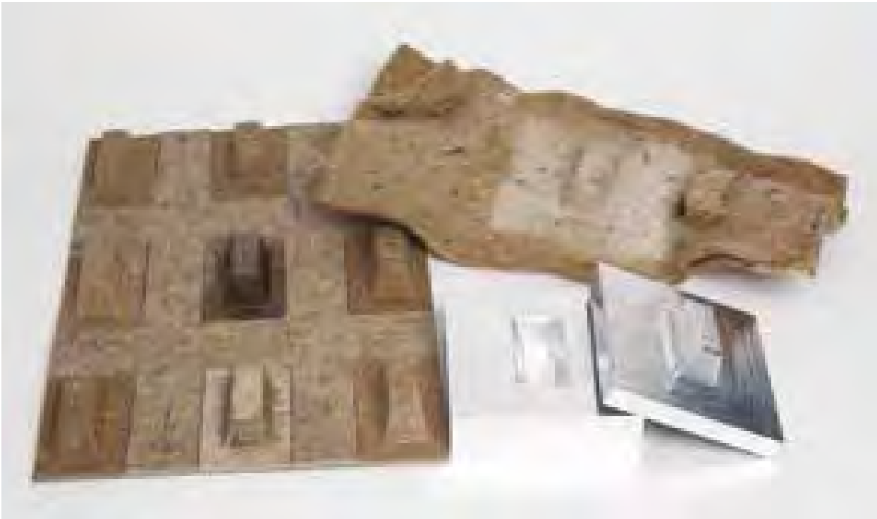
Afbeelding 2.2 Driedimensionale vormen door persen in een mal.
