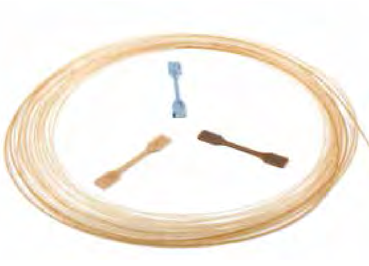
Filament van PLA en jute restvezel voor gebruik in een 3D printer.
