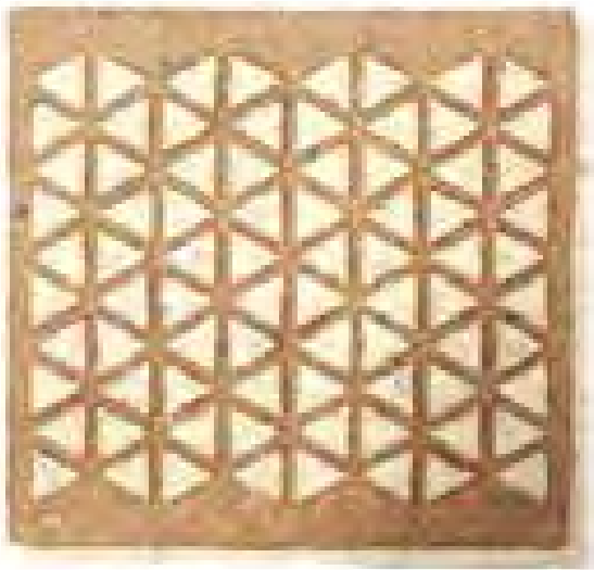
Afbeelding 3.5 Creëren van harde en zachte oppervlakken door middel van lasersnijden.
