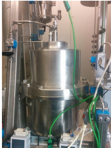
Zuurstofgeleidende omgekeerde brandstofcel in hoge-druk hoge temperatuur electrolyse reactor ontwikkeld bij TU-Delft
