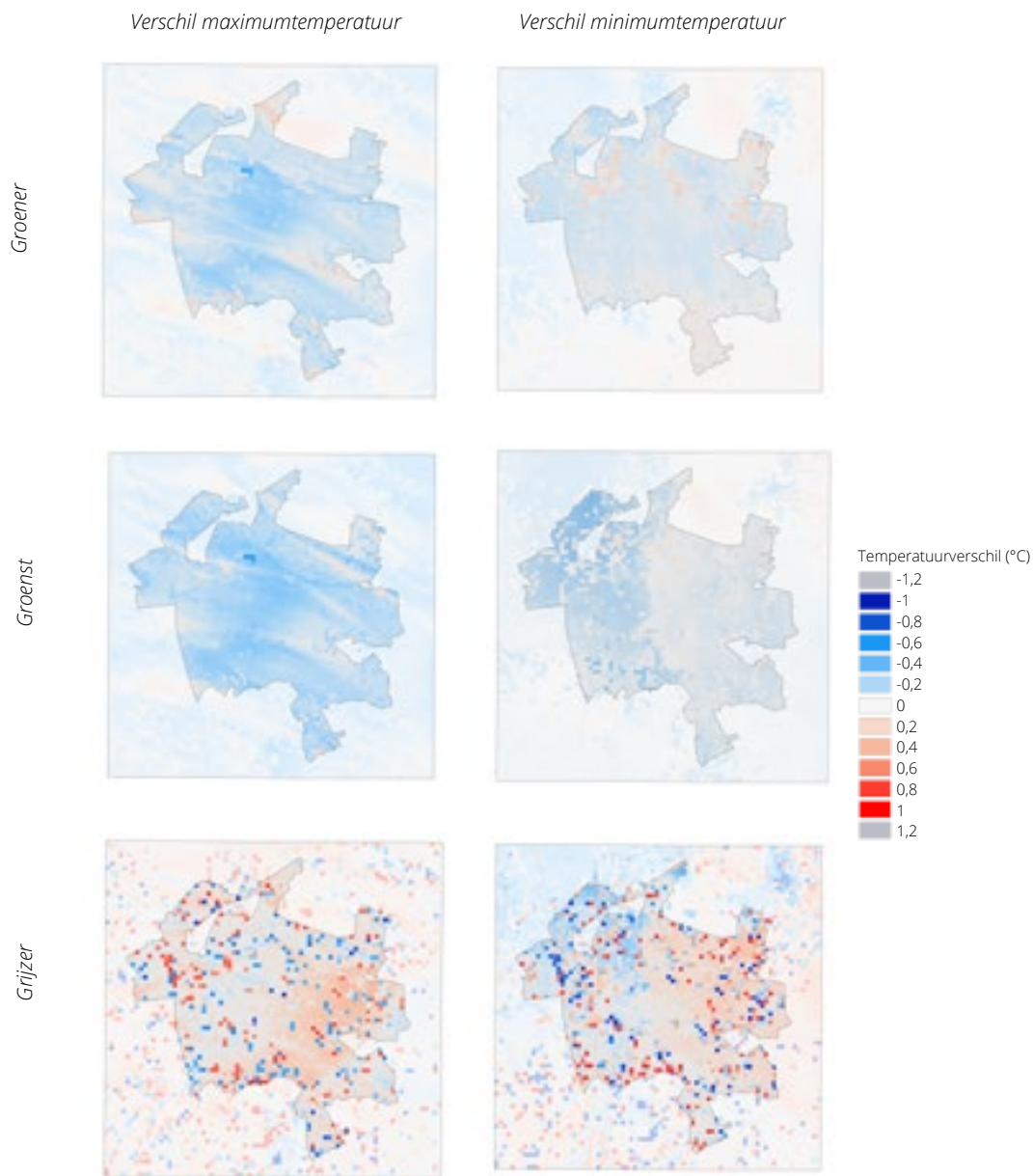
Figuur b.5 Door WRF berekende ruimtelijke patronen van de temperatuurverschillen tussen de verschillende scenario's en de referentiesituatie, op 27 juli 2018. Van boven naar beneden: Groener, Groenst en Grijzer; Links: verschillen voor maximumtemperatuur; rechts, verschillen voor minimumtemperatuur. Negatieve verschillen duiden op verkoeling.
