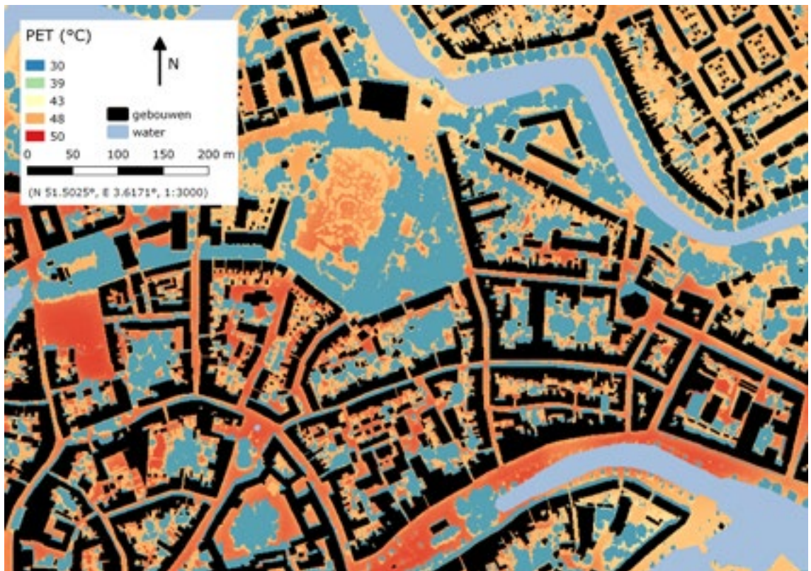
Figuur 2.4. Voorbeeld van een temperatuurkaart. In dit geval van de gevoelstemperatuur (PET) in Middelburg volgens de Nederlandse standaard.
